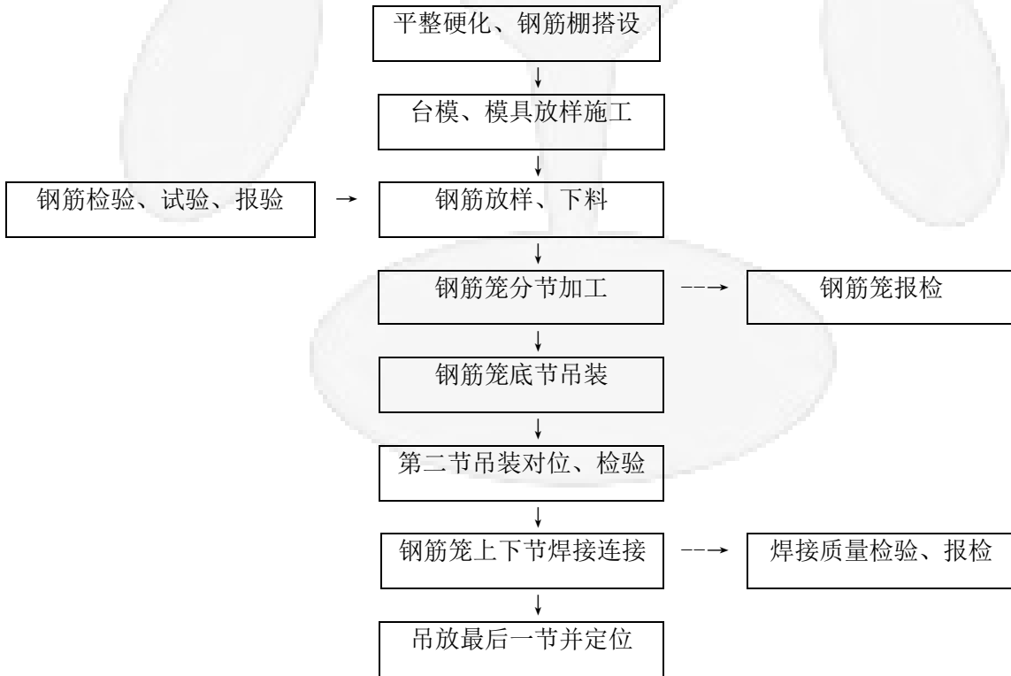
钻孔灌注桩钢筋笼制作及安装工艺流程图
